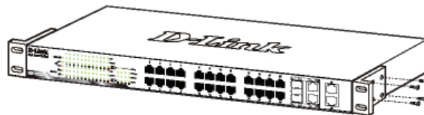
図2 ラックマウントキットを取り付ける
